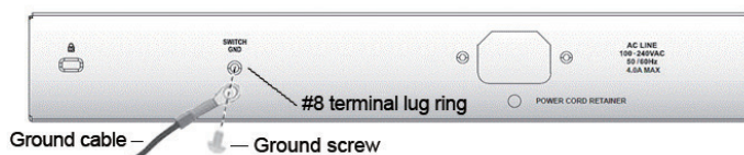
Abbildung 6. Anschluss eines Erdungskabels
