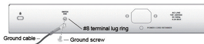
Figura 6. Collegamento di un cavo di messa a terra
